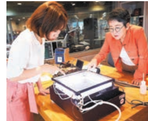
放射線の飛跡が確認できる装置「霧箱」で、空気中の放射線の存在を確認する近江アナ(左)と岡田さん
